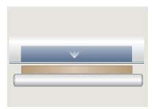
**Der nicht segmentierte Druckbalken** schleift ebene Werkstücke. Oft kommt er direkt nach Kalibrieraggregaten zum Einsatz.
